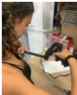
Il·lustració 39: Posant silicona per sellar el tub. Font: Propia
