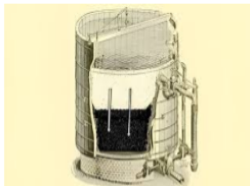
Il·lustració 7: Filtre de sorra per la potabilització d'aigua.
