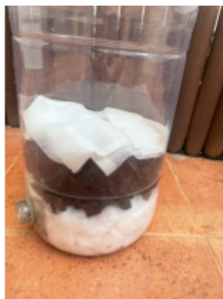
Il·lustració 35: Nou filtre amb cotó i gases. Font: Propia
